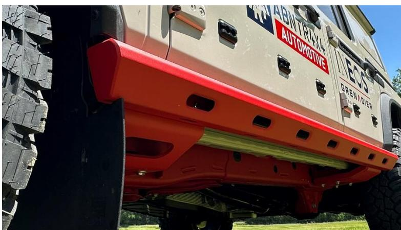
6. Klemmplatte (6) in den Rockslider einfädeln und durch die äußeren Langlöcher im Rockslider mit Scheibe und Mutter handfest anziehen. Die gefräste Nut der Klemmplatte muss sauber im Rockslider einrasten! Bei einer Fehlmontage ist es möglich, dass sich die Fahrzeugtüren nicht öffnen lassen.
