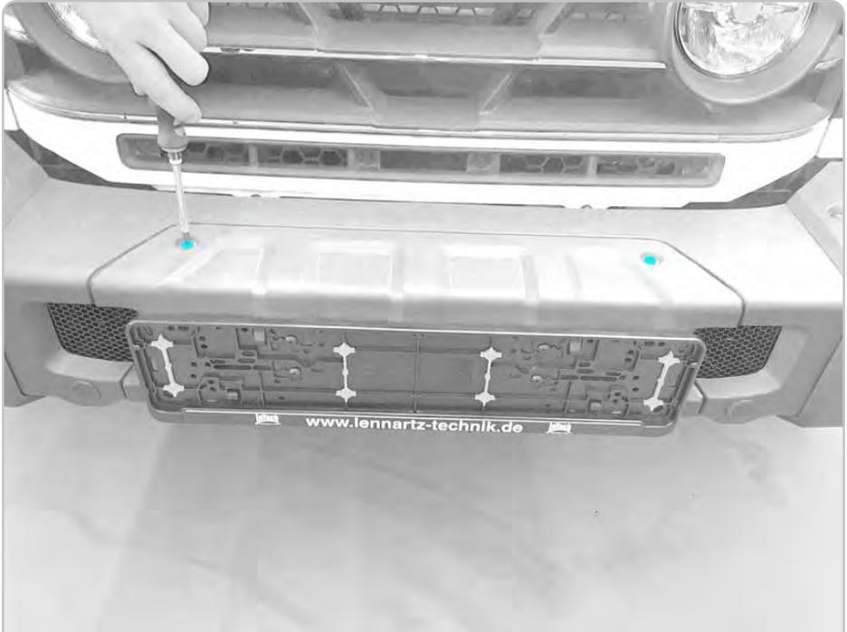
Die zwei Schrauben der original Seilwindenabdeckung lösen und die Abdeckung aus der Stoßstange ausfahren.
