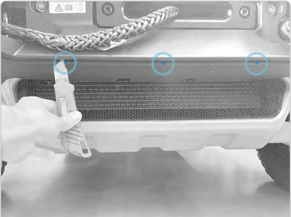
Die Angüsse in der Stoßstange mit einem geeigneten Werkzeug entfernen.
