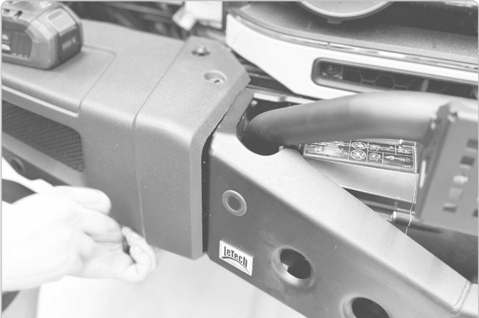
Anschließend die Seitenblenden wieder mit Originalschrauben anbringen (12Nm).
